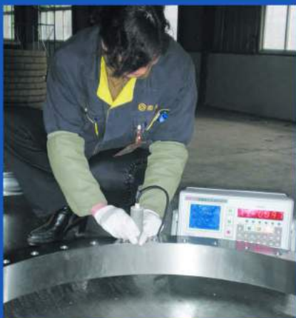
Тестирование на наличие микротрещин
